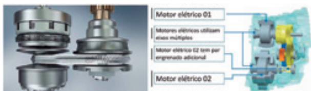
Figura 4. Transmissão CVT convencional e transmissão e-CVT. Fonte: Autoentusiastas / Toyota.
